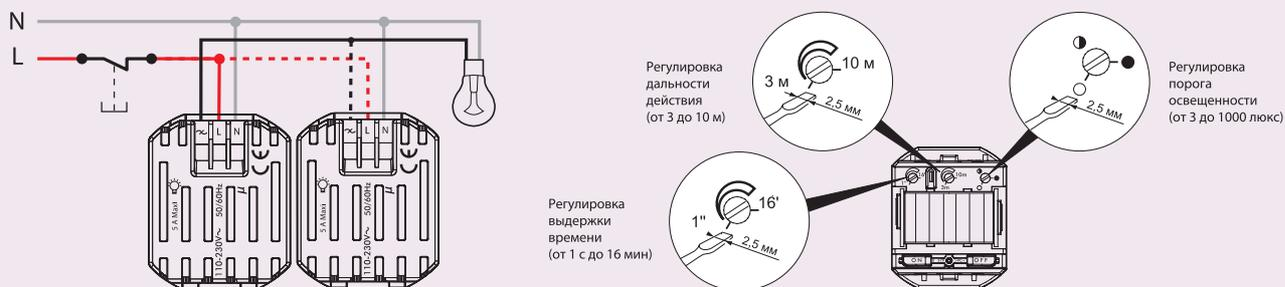
**Важное замечание:** Не использовать изделие для управления дистанционным выключателем вместо кнопки. При параллельном подключении каждое изделие функционирует независимо, при этом включение остается приоритетным.
